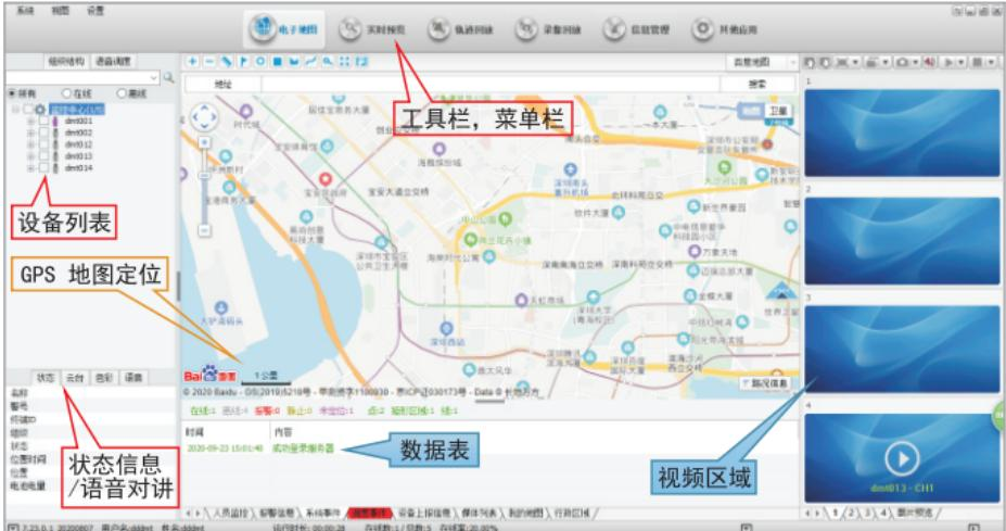
1. 设备列表中可以观察设备的状态信息、成员在线信息，其中图标黄色表示设备在线并且获取到GPS位置信息；粉红色图标表示设备在线但GPS信号未被获取到，灰色图标表示设备离线。
